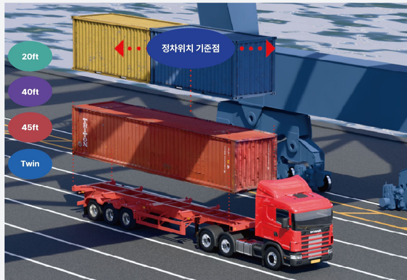
작업중인 Container 종류별 위험지역 설정 양,적하, Size, 작업 방향 등은 자동으로 감지하여 위치를 판단
